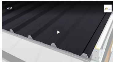
امروزه از حبدترین مصالح موجود در ساختمان سازی، می‌توانیم به ورق های مصرفی در تولید سادنوج پابل اشاره کیم، سادنوج بابل سقفی و سادنوج باطل دوروازی از دو ورق بازک از جنس ورق کالاونیس، ورق الوریس، ورق ایسلوپیومی و روق رنگی سستکل سنده که در بین آن، عایق های مدل سنگ، پلاستیک، پشم شیشه و پلی استر ایوانک کرافت است که برای افزایش عمر ایوانک های حاج، رنگ یا لاینمدی وی آن قرار گیرد.
